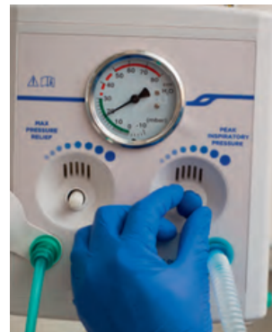
Ilustración 62: ajuste de parámetros como el PIP y la PEEP
