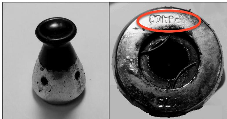
**Figura 18:** Válvula de seguridad (“pituto”) de una olla a presión. En el círculo rojo se indica la presión límite de activación (80 kPa).
