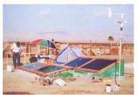
Figura 1.5.2 Destilador de bandejas
