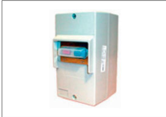
Las características principales de los guardamotores, al igual que de otros interruptores automáticos magneto-térmicos, son la capacidad de ruptura, la intensidad nominal o calibre y la curva de disparo. Proporciona protección frente a sobrecargas del motor y cortocircuitos, así como, en algunos casos, frente a falta de fase.
